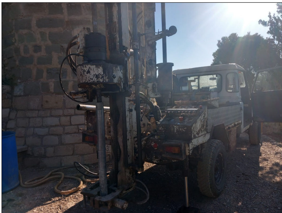
Figura 8. Maquinaria utilizada para la ejecución de los sondeos.
