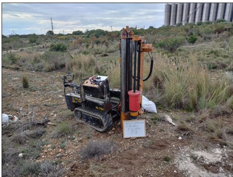
Figura 10. Maquinaria utilizada para la ejecución de los ensayos de penetración dinámica DPSH.
